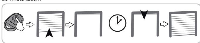
Une nouvelle commande pendant ce délai annule la fermeture automatique et la porte reste ouverte.
