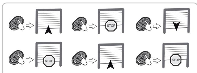
**> Fonctionnement de la détection d'obstacle**
