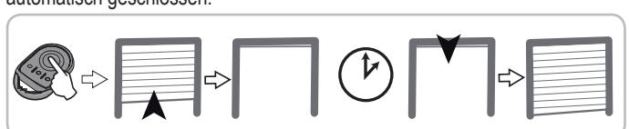
Wird während der Verzögerung ein neuer Befehl eingegeben, wird die automatische Schließung aufgehoben und das Tor bleibt geöffnet.
