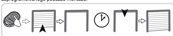
Wysłanie kolejnego polecenia sterującego w czasie trwania tego okresu anuluje automatyczne zamykanie i brama pozostaje otwarta.
