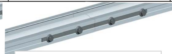
(NL) Montage van de rails: zorg dat de verschillende delen van de rails op een vlak oppervlak gemonteerd worden. Gebruik de schroeven en de onderdelen genummerd om de rails en de bevestigingsstang aan het plafond in elkaar te zetten. Breng de schroeven zo dicht mogelijk tegen de rail aan en draai een halve slag. Controleer of de rails naar behoren op elkaar zijn aangesloten. Blokkeer de schroeven niet. Neem de markering (midden) op de montagestiften in acht.
