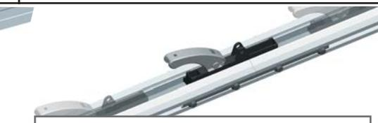
(E) Montaje del rail teniendo la precaución de poner las partes del rail sobre una superficie plana. Utilizar la tornillería y las piezas marcadas para ensamblar los railes, así como la barra de unión con el techo. Acercar todo lo posible los tornillos al rail y apretar 1/2 vuelta. Verificar que los railes están correctamente empalmados. No bloquear los tornillos. Respetar el marcado (centro) de las barras de ensamblaje.
