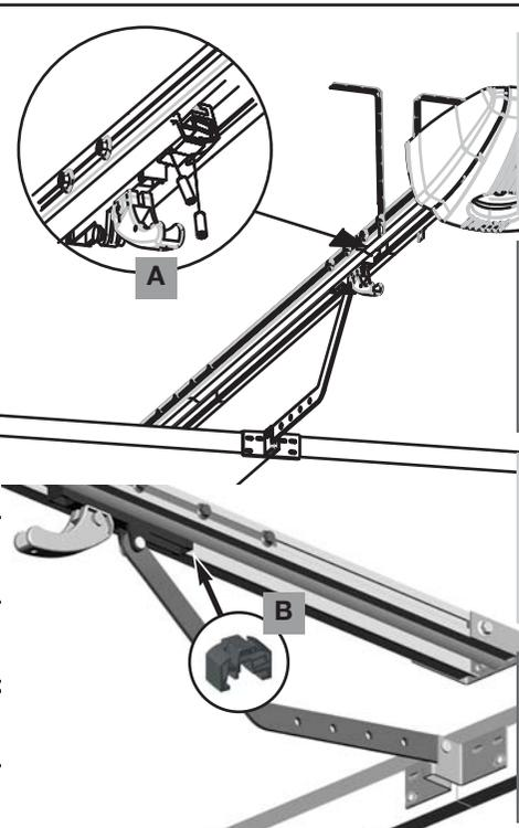
(F) **Installation et réglage des butées du rail.** Déverrouiller le chariot mobile puis ouvrir normalement la porte sans aller plus loin que nécessaire et sans contrainte, positionner la butée contre le chariot puis serrer les deux vis de la butée (A). Fermez complètement la porte, positionnez et serrez la butée de fermeture contre le chariot (B).
