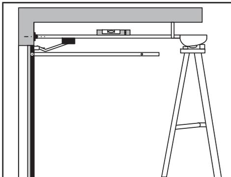
(F) Poser le bloc moteur sur un escabeau pour le fixer. Vérifier l'horizontalité du rail avec les guides de la porte.
