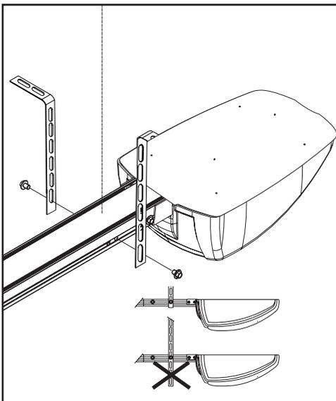
(F) Fixer le rail au plafond en utilisant les pattes de fixation. Les plier en fonction de la configuration du garage et les renforcer si nécessaire. Couper les pattes de fixation à la bonne longueur.
