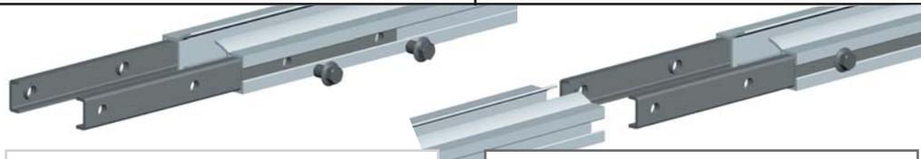
(F) Placer les parties du rail sur une surface plane. Utiliser la quincaillerie pour réaliser l'assemblage des rails ainsi que la barre d'attache au plafond. Approcher les vis au plus près du rail et serrer de 1/2 tour. Vérifier la bonne jonction des rails. Ne pas bloquer les vis. Respecter le marquage (milieu) sur les barrettes d'assemblage.
