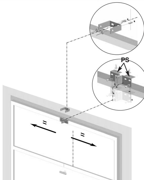
(F) Centrer la patte d'attache sur la porte. La fixer solidement à la structure du garage.
