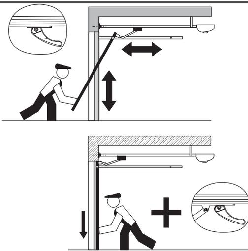
(F) Manœuvrer manuellement la porte pour vérifier le bon fonctionnement mécanique. Refermer manuellement la porte et verrouiller le levier.
