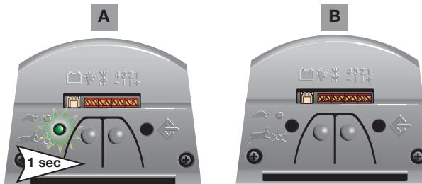
**(NL) Kies het type naderingssnelheid door te drukken op de snelheidstoets.**
