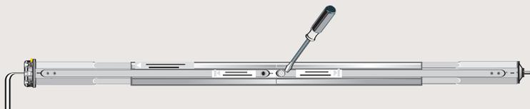
29 Fixer la lamelle de réglage à l'aide des vis auto foreuses prévues à cet effet.
