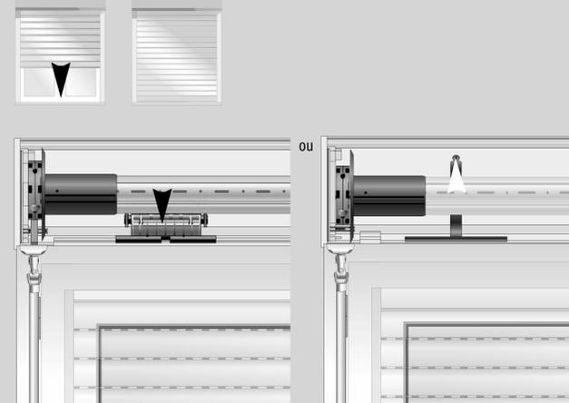
3 Démontez la manivelle en dévissant la sortie de treuil et sortez le cardan.
