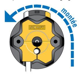
Si votre moteur tourne dans de le sens des aiguilles d'une montre, le bouton jaune correspond au réglage de votre butée haute. (Le bouton blanc correspondra donc au réglage de la butée basse.)
