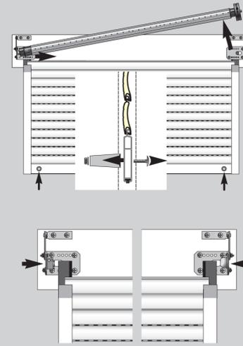
[8] Enlever le support embout et le support treuil. Ne pas démonter les équerres existantes.
