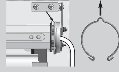
[20] Verrouiller le support embout avec la vis.
