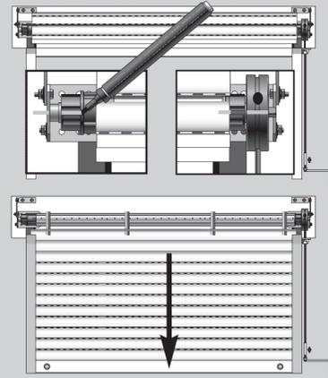
[4] Descendre le volet. Pour axe compensé : En comptant le nombre de tours effectués par l'axe. (grâce aux repères réalisés en étape 3).
