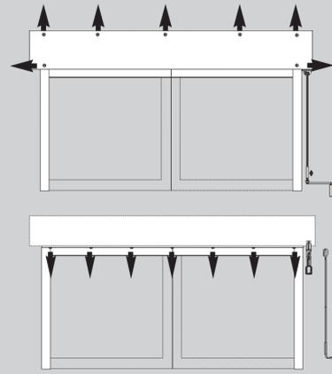
[2] Coffre tunnel : Retirer la sous face (à l'expérier) pour avoir accès au volet roulant.
