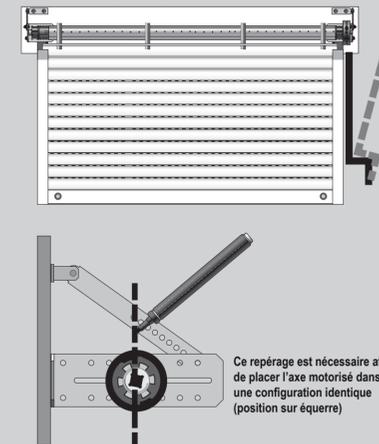
[6] Repérer le sens d'enroulement du volet. Repérer la place exacte de l'axe sur les 2 équerres support.
