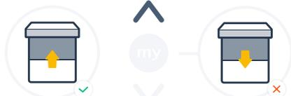
Si le volet roulant monte, le sens de rotation est **correct**, passez au chapitre suivant.
