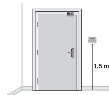
**1** Se servir du fond comme gabarit de perçage. Fixer le boîtier électronique au mur, et **non sur une partie métallique**.
