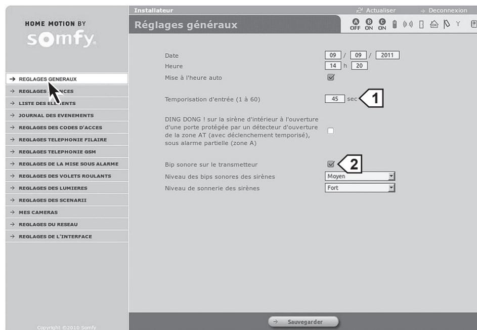
**1** Réglage de la temporisation avant le déclenchement de l'alarme, pour un détecteur d'intrusion en zone A Temporisée.
