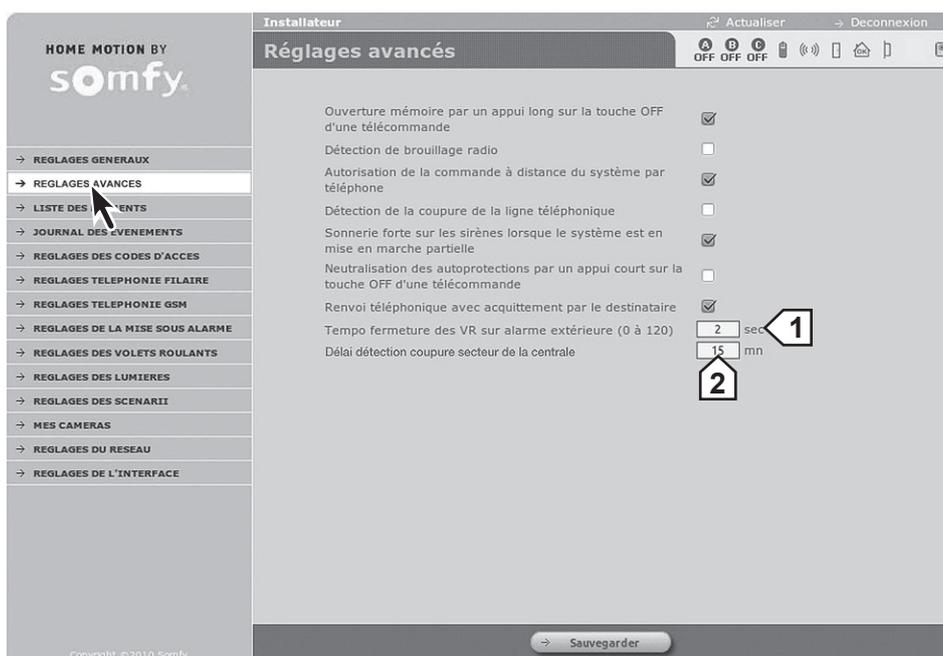
**1** Réglage de la temporisation des volets roulants liée au fonctionnement du détecteur de mouvement extérieur.
