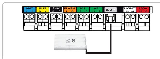
Installez la batterie sur l'électronique du boîtier de commande avec un adhésif double-face.
