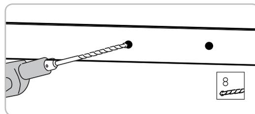
9 Fixez la patte de fixation vantail aux deux points sur les vantaux en utilisant des vis adaptées au matériau du renfort et les rondelles (11) fournies.
