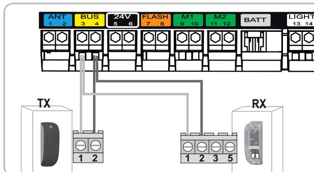
● **Reconnaissance des cellules par l'électronique du moteur en mode séquentiel**
