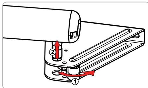
7 Repositionnez la patte de fixation vantail puis marquez les trous de fixation **au centre des trous oblongs**.
