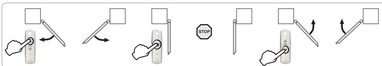
**Ouverture** par un appui sur la touche Montée
