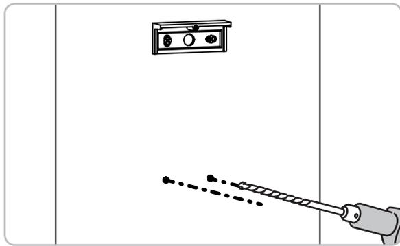
**7** Fixez le fond du boîtier au pilier/mur : 1 vis (18) pour fixer le boîtier à l'équerre + 2 vis pour fixer le boîtier au pilier/mur.
