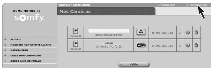
Les caméras en mode filaire, avec le câble réseau Ethernet, sont désormais opérationnelles. Passer au chapitre fixation en page XX.
