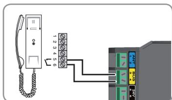
Raccordez l'interphone aux bornes 3 et 4 (étiquette jaune «BUS») du boîtier électronique.
