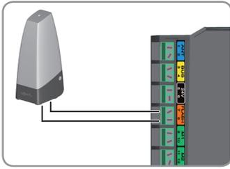
Raccordez le feu orange aux bornes 7 et 8 (étiquette orange «FLASH») du boîtier électronique.
