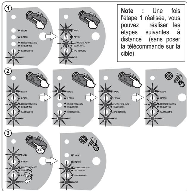
Pour désactiver le mode fermeture automatique et revenir en mode séquentiel, répétez l'étape 1 ci-dessus puis faites un appui bref sur la touche 2 ● de la télécommande, le voyant FERMETURE AUTO s'éteint puis clignote. Appuyez 2 fois sur la touche 1 ● de la télécommande.
