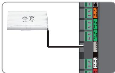
Raccordez la batterie à la borne prévue à cet effet (étiquette grise «BATT») du boîtier électronique.
