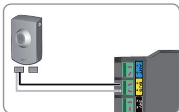
Raccordez le contact à clé aux bornes 3 et 4 (étiquette jaune «BUS») du boîtier électronique.
