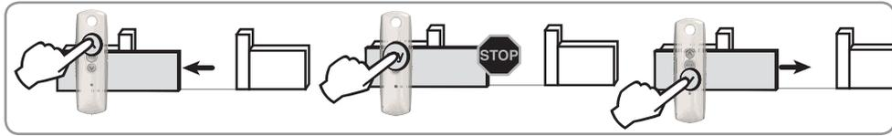
**Ouverture** par un appui sur la touche Montée
