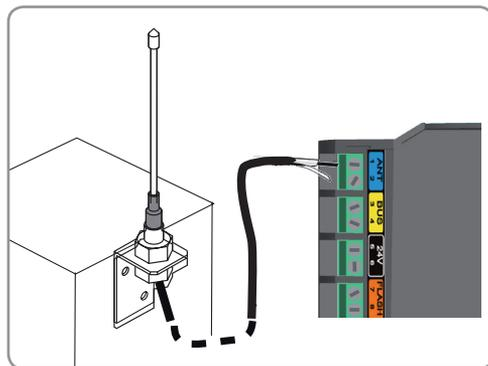
Une antenne déportée de plus longue portée peut remplacer l'antenne fil.
