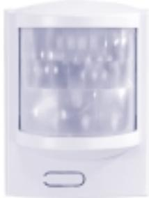
Destiné à surveiller, **à l'intérieur de votre habitation**, une pièce ou un espace, il réagit à la conjugaison du mouvement et du rayonnement infrarouge émis par un individu se déplaçant dans son champ de vision. Ce dernier s'exerce sur un rayon de 12 mètres avec un angle de 90°. Lors d'une détection, le détecteur retransmet l'information à la centrale et la sirène se déclenche pendant 2 minutes.
