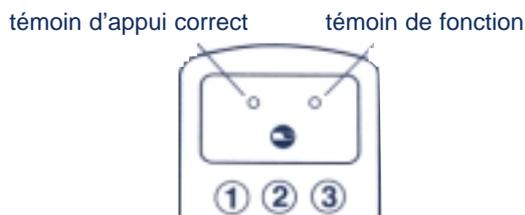
2 - en cas d'erreur lors de l'exécution du code, ouvrir le clavier, enlever les piles, attendre 15 secondes, remettre les piles, refermer le clavier et recommencer l'initialisation comme indiqué précédemment.
