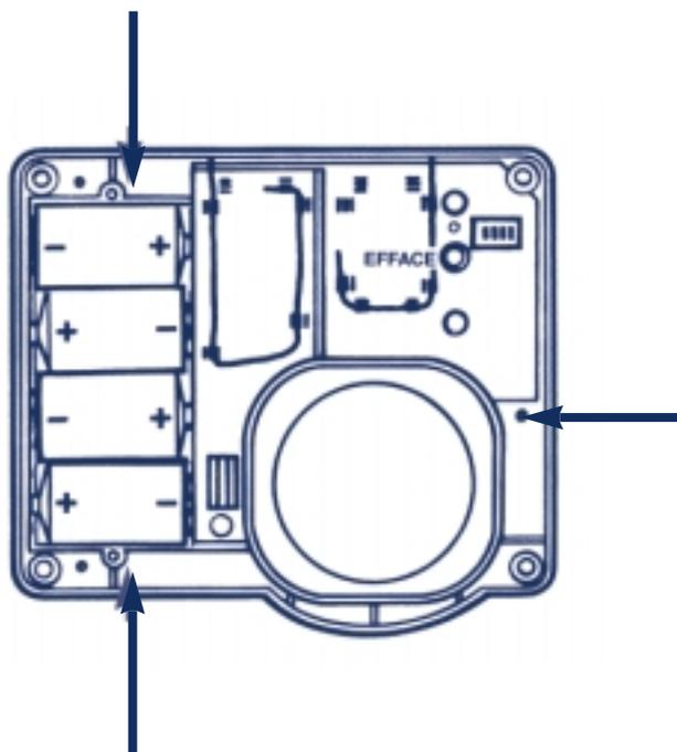
La sirène extérieure/sirène extérieure avec flash est protégée contre les projections d'eau et le ruissellement. La sirène est d'une puissance de 101 dB +/- 6 dB. Choisir un endroit abrité.
