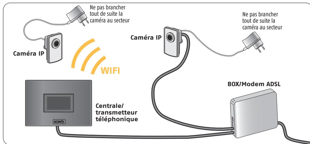
En cas de connexion à un réseau sans fil de type wifi, la **connexion filaire est temporaire**, elle est utilisée pour la configuration des paramètres de connexion sans fil de la caméra.
