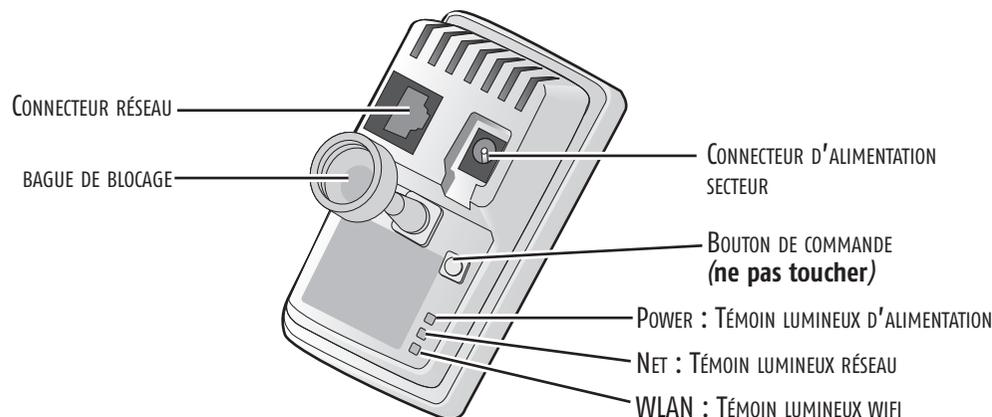
Connecter le câble réseau Ethernet d'une part à la Caméra IP, d'autre part à un port RJ 45 disponible sur votre box/modem ADSL. Si aucune prise Ethernet n'est disponible sur votre box/modem ADSL, vous pouvez temporairement libérer une prise Ethernet. Vous pouvez également ajouter un switch 10/100 Mbits/s (multiprise Ethernet).
