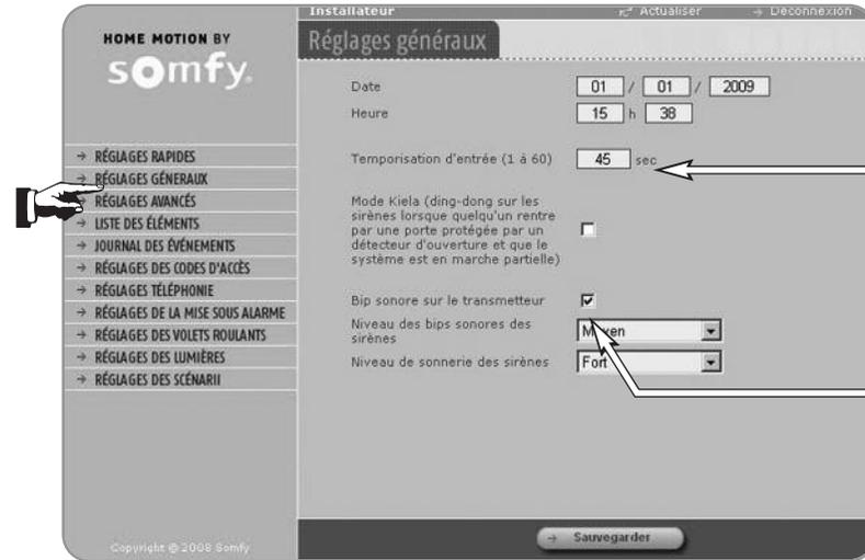
... avant le déclenchement de l'alarme, pour un détecteur d'intrusion en zone A Temporisée
