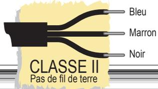
*Le Dirigo dispose d'une conception électrique «double isolation». Son raccordement sur le secteur 230 V peut être réalisé sans risque même en l'absence d'un conducteur de protection (fil de terre Jaune/Vert).*
