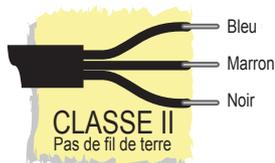
*Le Dirigo dispose d'une conception électrique «double isolation». Son raccordement sur le secteur 230 V peut être réalisé sans risque même en l'absence d'un conducteur de protection (fil de terre Jaune/Vert).*
