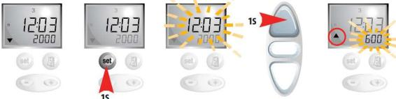
Régler l'heure de montée de ce jour avec les touches « + » ou « - » Faites une impulsion sur la touche « calendrier » pour passer au jour suivant. Modifiez l'heure de montée avec les touches « + » ou « - »
