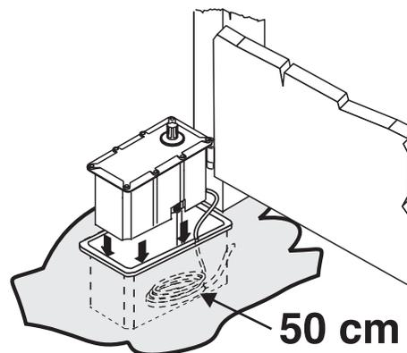
NL Verwijder de beschermkap en de plastic buis en voer de kabel door de buis. Zorg ervoor dat +/- 50 cm kabel in de plastic behuizing overblijft om de motor eventueel te kunnen verwijderen. Herhaal deze procedure voor de 2e motor.
