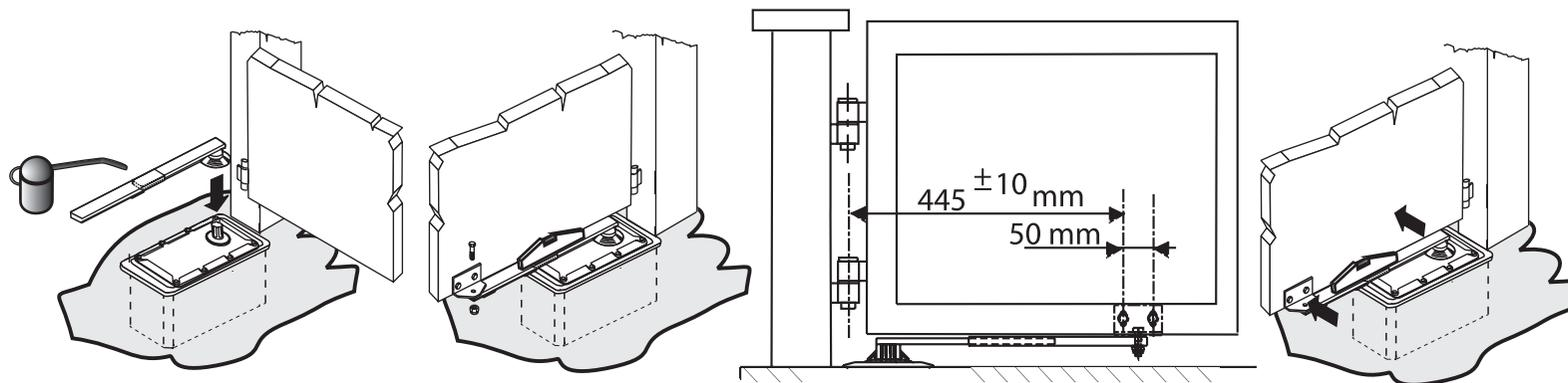
F Graisser le bras et le monter sur le moteur. Fermer le vantail et fixer la patte vantail au bras du moteur puis fixer celle-ci sur le vantail en respectant les dimensions données.
