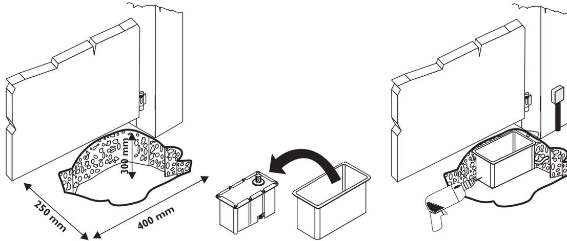
⑦ Maak het gat op basis van de bovenstaande gegevens (4 en 5). Neem de motor uit de behuizing en plaats de behuizing waterpas in het gat.
