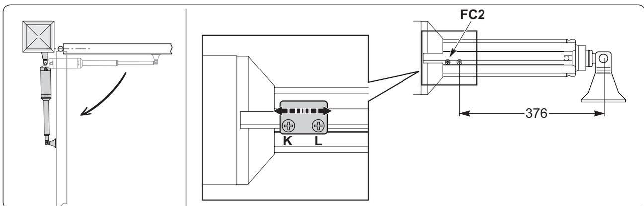
**Nota :** lors de la programmation de la commande électronique, il est nécessaire d'anticiper légèrement l'intervention des butées de fin de course. Afin d'avoir un appui parfait sur les butées au sol, le vérin continue son mouvement sur 1 ou 2 cm (environ 100 ms).
