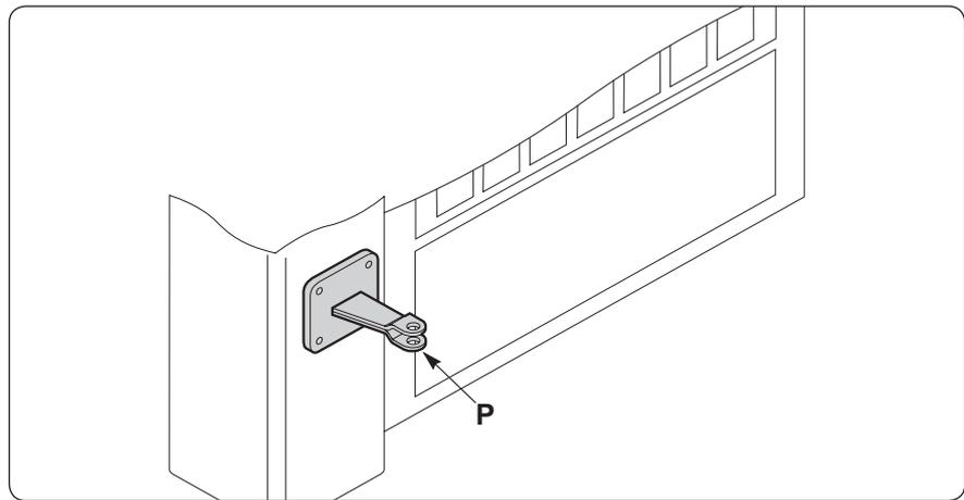
**Nota :** utiliser les gros circlips pour fixer la patte **P**.
