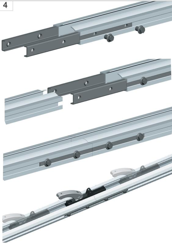
Ⓕ Placer les parties du rail sur une surface plane. Utiliser la quincaillerie pour réaliser l'assemblage des rails ainsi que la barre d'attache au plafond. Approcher les vis au plus près du rail et serrer de 1/2 tour. Vérifier la bonne jonction des rails. Ne pas bloquer les vis. Respecter le marquage (milieu) sur les barrettes d'assemblage.
