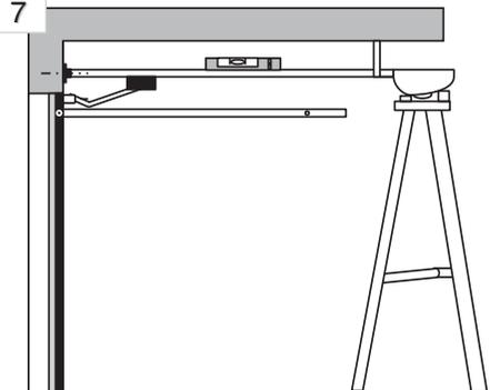
Ⓕ Poser le bloc moteur sur un escabeau pour le fixer. Vérifier l'horizontalité du rail avec les guides de la porte.
