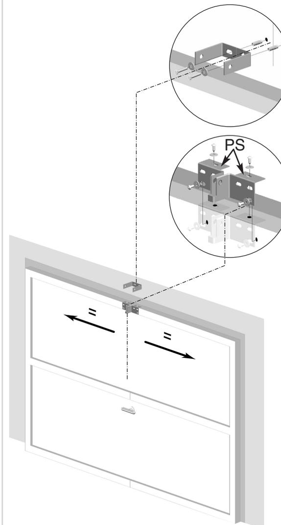
Ⓕ Centrer la patte d'attache sur la porte. La fixer solidement à la structure du garage.
