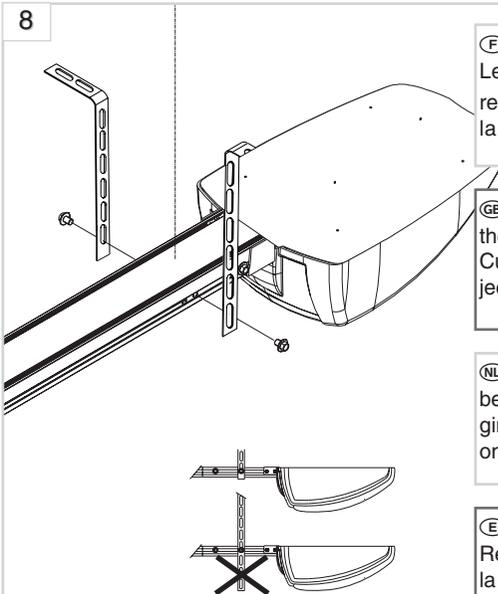
Ⓕ Fixer le rail au plafond en utilisant les pattes de fixation. Les plier en fonction de la configuration du garage et les renforcer si nécessaire. Couper les pattes de fixation à la bonne longueur.
