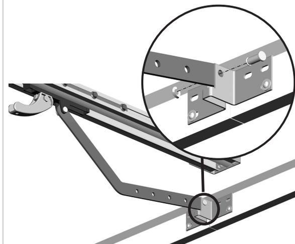
Ⓕ Sujetar el brazo de unión sobre el carro móvil.
