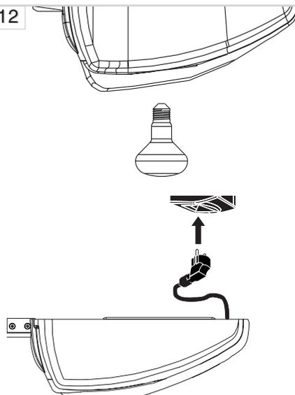
ⒻE Installer l'ampoule. Brancher le cordon d'alimentation du moteur sur la prise de courant prévue à cet effet.
