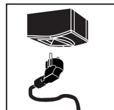
Ⓖ Sluit de voedingskabel aan op een contactdoos die uitsluitend hiervoor dient en voldoet aan de elektrische normen. De voeding moet van een beschermingsinrichting voorzien zijn (zekering of automaat 16A) en van een differentiaal inrichting (30mA).
