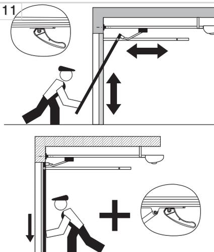
ⒻE Manoeuvrer manuellement la porte pour vérifier le bon fonctionnement mécanique. Refermer manuellement la porte et verrouiller le levier.
