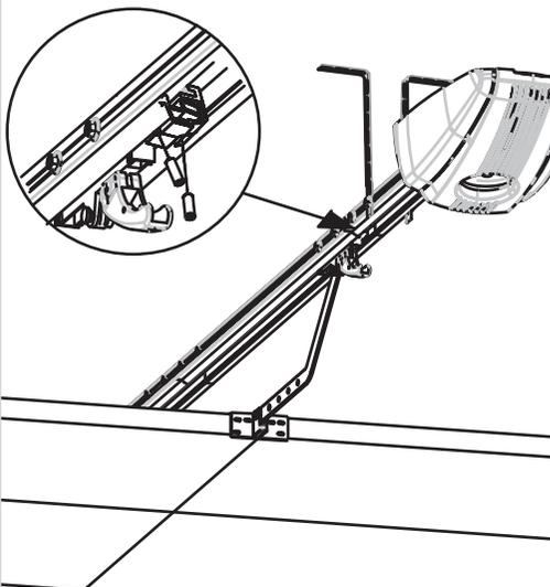
Ⓕ Installation et réglage de la butée du rail. Déverrouiller le chariot mobile puis ouvrir normalement la porte sans aller plus loin que nécessaire et sans contrainte, positionner la butée contre le chariot puis serrer les deux vis de la butée.
