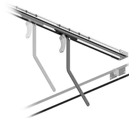
Ⓖ Bevestig de verbindingsarm aan de mobiele slee.
